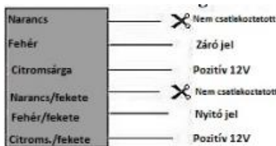
('B' ábra: pozitív kioldó kábelezés ábrája)
