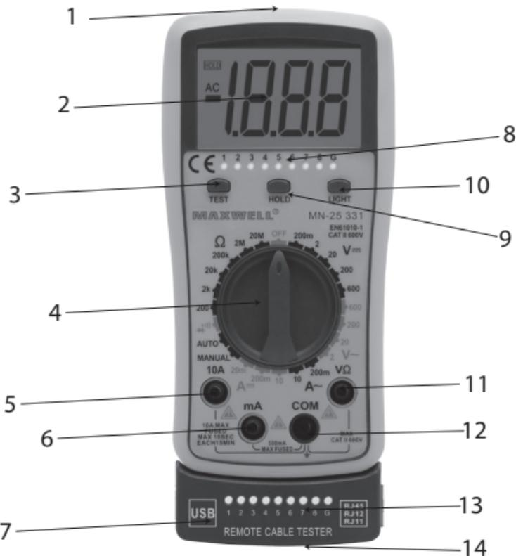
1. Rj45, RJ11, RJ12, USB teszt csatlakozó
