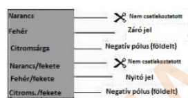
(C ábra: negatív kioldó kábelezés ábrája)
