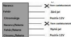
('B' ábra: pozitív kioldó kábelezés ábrája)
