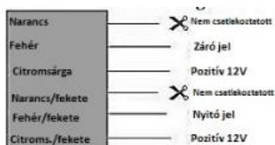
('B' ábra: pozitív kioldó kábelezés ábrája)
